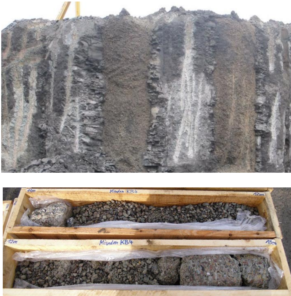
Abbildung 2: Großversuch oberhalb des Grundwasserspiegels mit Primärpfählen aus Dränbeton und Sekundärpfählen aus üblichem zementgesättigten Beton und zugehöriger Bohrkern (entmischter Kies im oberen Bereich, dichter Zementstein im unteren Bereich)
