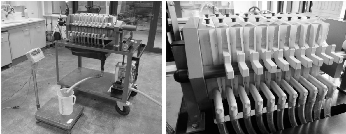
Abbildung 14: Labor-Kammerfilterpresse: Versuchsaufbau (links), Kammer (rechts)
