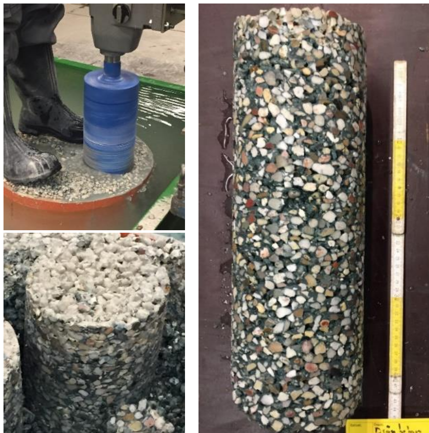
Abbildung 6: Erfolgreiche Kernbohrung nach 7 Tagen Erhärtungszeit unter Wasser
