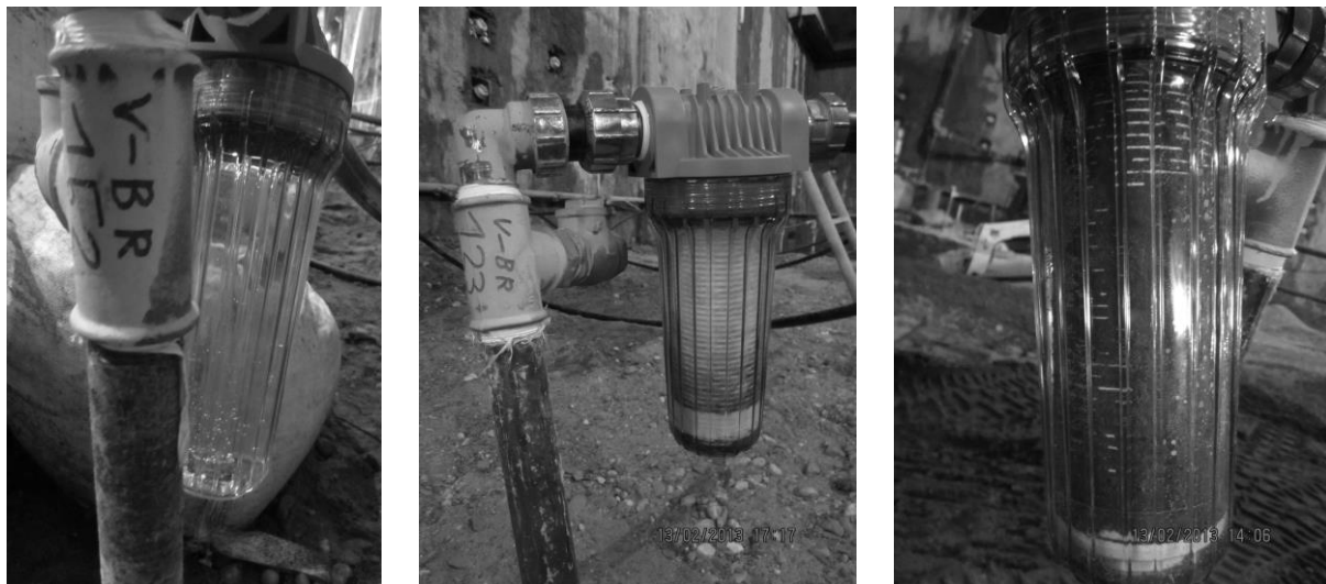
Abbildung 4: Einzelfilter, zunächst noch ohne Filtereinsatz (links), mit Sandfracht (rechts)
